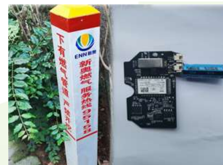
智能警示桩应用，实现管网状态实时监测，减少管损发生
