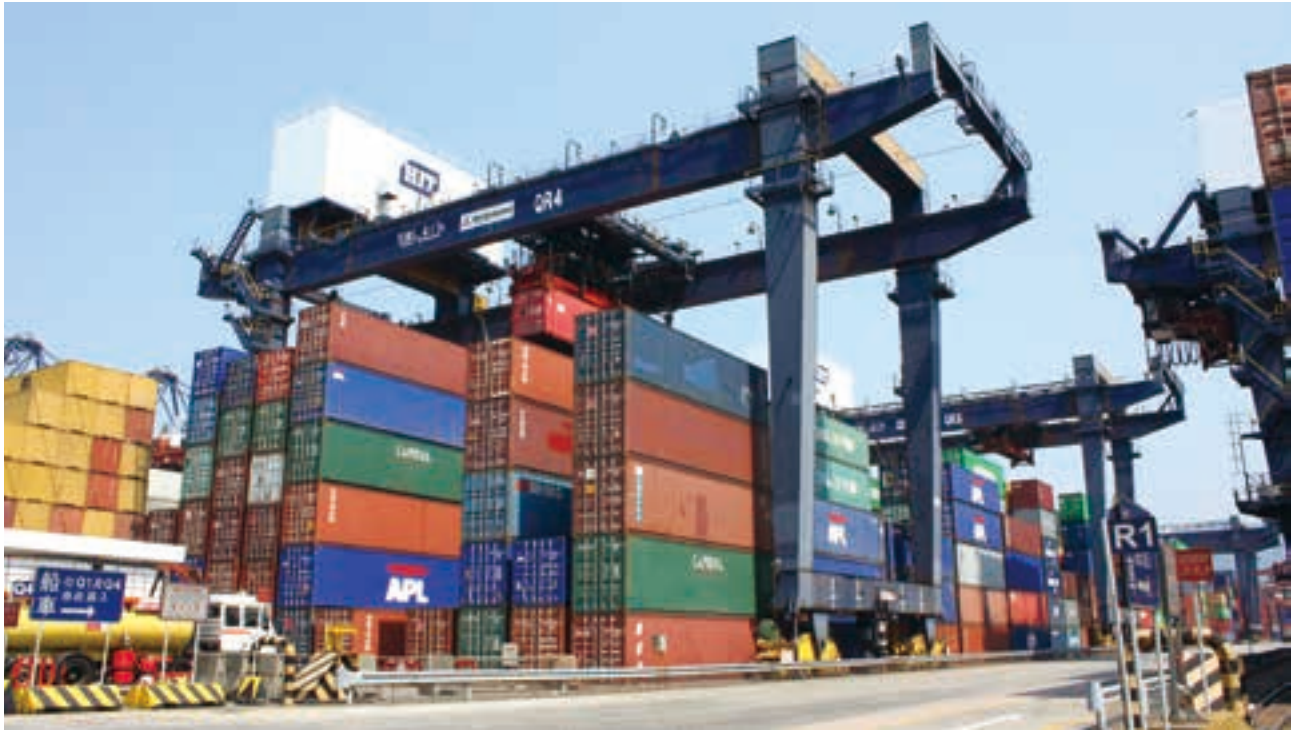
香港國際貨櫃碼頭現正興建電子龍門遙控中心，以操作二十四台路軌式電子龍門架吊機。
