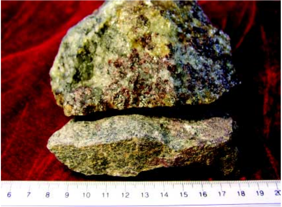
圖5 該項目的高品位金紅石礦石 (岩石上深紅色的礦物是金紅石。相片中的比例以厘米為單位。)
