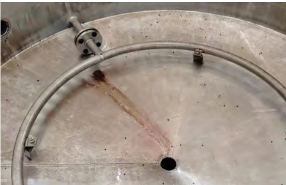
溢流管降低的節水底銅
