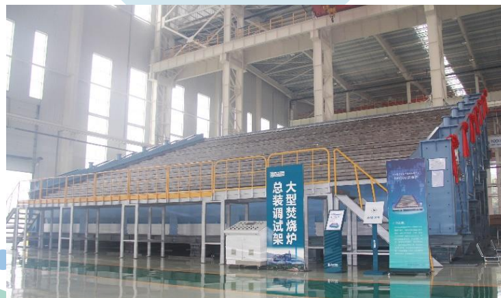
自主研发的1,000吨/日炉排
