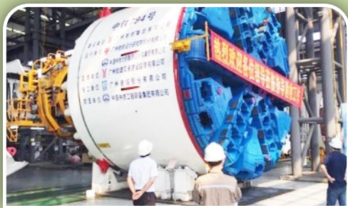
China Railway Engineering Project - Tunnel Boring Machine 中鐵工程項目 - 盾構機
