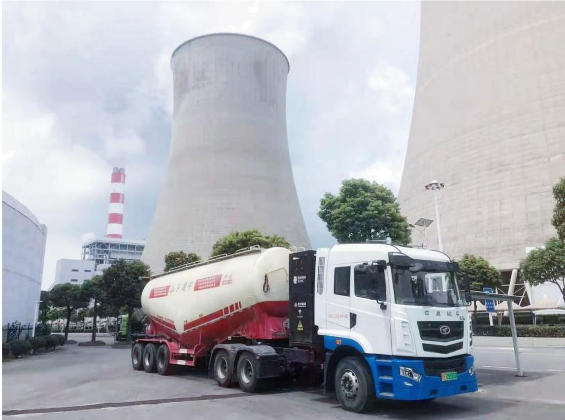
中國電力平圩發電公司積極探索嘗試，力求實現發電副產品運輸車輛及內部工程車輛“換電”綠色運輸。公司積極與上海融和電科啟源芯動力合作，選取安徽鳳台海螺水泥廠粉煤灰運輸為應用場景，開展換電重卡平原地區應用場景測試，採集了換電重卡能耗、續航里程等關鍵指標，進行了油電替代經濟性比較。資料顯示電動重卡具有清潔、節能、性價比高的優勢，在化石能源替代和減少碳排放上具有獨特優勢。
