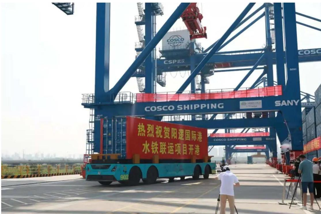
這裏，不止是水鐵聯運。在這裏，「智慧港口」技術正與長江第一大水鐵聯運樞紐逐步融合。作爲智慧港口建設上的關鍵一環，開港活動當天執行任務的這台無人駕駛集裝箱卡車（無人集卡「DCV」）由中遠海運港口與東風商用車、中國移動基於 5G 和北斗高精定位技術合作開發。港口無人集卡系統集成了調度系統等五大模塊，這些模塊構成了港口水平運輸自動化系統。其中，無人集卡實現定位精度 $\leq 5\text{cm}$ ，一次定位準確率 $\geq 90\%$ ，無人集卡車隊投入運營後可實現與有人集卡混合作業。
