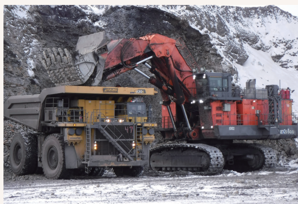
Ex5500挖掘機正在裝載小松830E礦車
