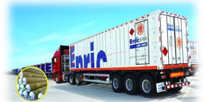
高压氢气储运
