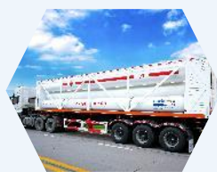
▲ 氢气管束运输车 ▲ 氢气储罐
