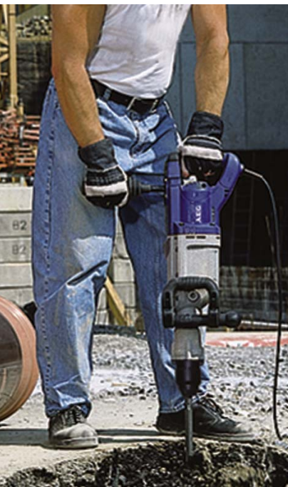
(上) AEG之嶄新拆卸錘機功能強大，可應付嚴峻之建築工地環境，採用創新設計之防震系統，所有手柄均加裝軟墊握手位。
