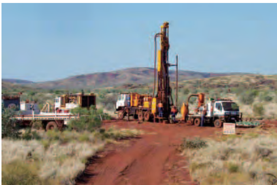
圖3 Marillana RC 鑽探
