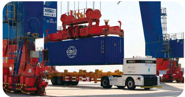
本公司在控股碼頭實施無人集卡項目，提高作業效率，以減少能源使用和溫室氣體排放。
