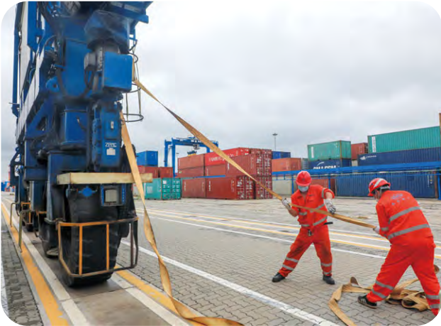
2022年9月，颱風「梅花」七級風圈直接影響正常生產秩序，南通通海碼頭按照本公司的防抗颱風工作指引對堆場集裝箱和碼頭設備進行加固，確保生命財產安全。
