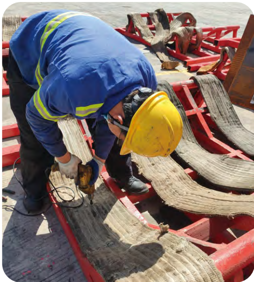
晉江太平洋碼頭的員工在鋼捲的鞍座安裝報廢吊裝帶，合理地將廢物循環再用。
