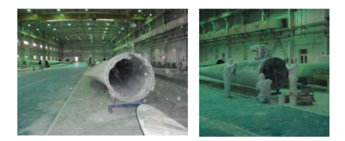
2010年,在全面總結2009年生產第一批葉片 生產質量控制情況後,葉片廠重點完成 900KW加長型模具的包括加強質量控制之生 產前準備,及啟動900KW加長型葉片批量生 產工作,為每台風機的發電量提高約10%, 2010年共生產135套900KW加長型葉片。
