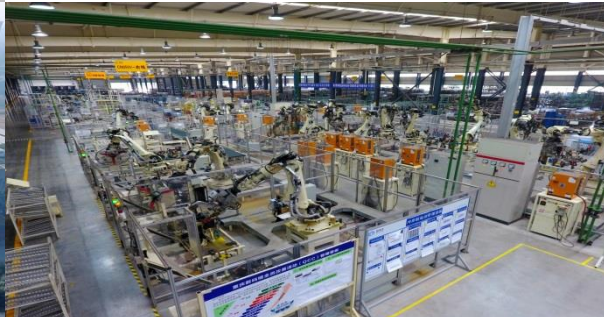
自動化焊接生產線
