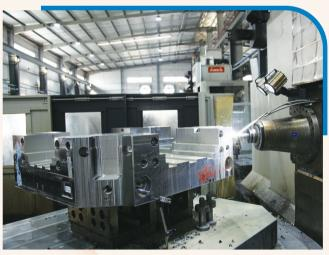
■式加工中心正為一件大型非標模架進行 切削形框及精孔
