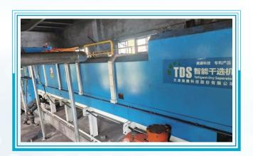
Picture: Intelligent dry separator used for clean production 圖:清潔生產使用的智能乾選機
